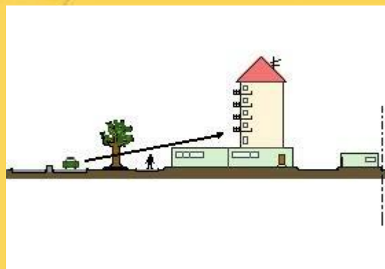
zajvédelmi szempontból nem megfelelő elhelyezés
