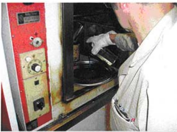
3. kép: A melegbitumen réteg előkészítése
