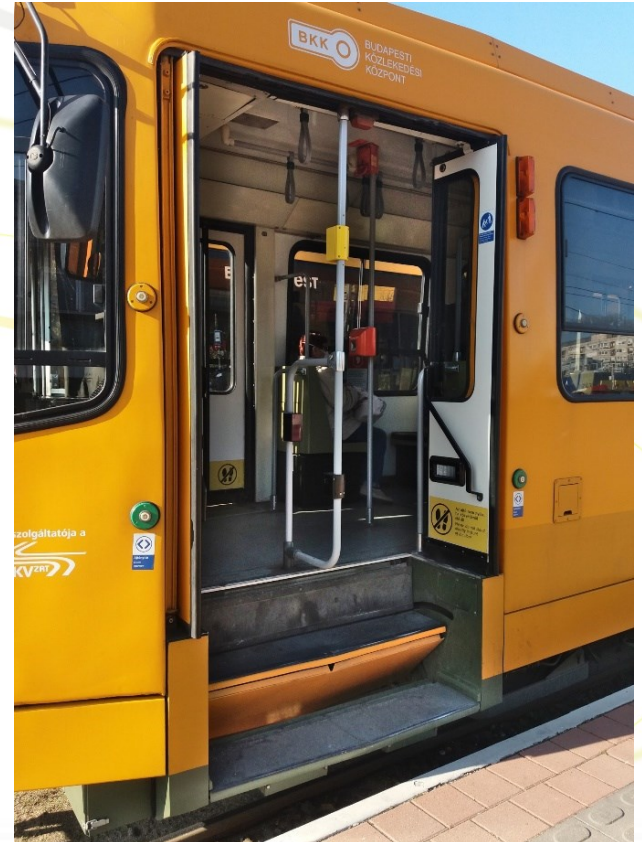
Lenyíló ajtós jármű két peronmagasság kiszolgálására (Hannover, Németország)
