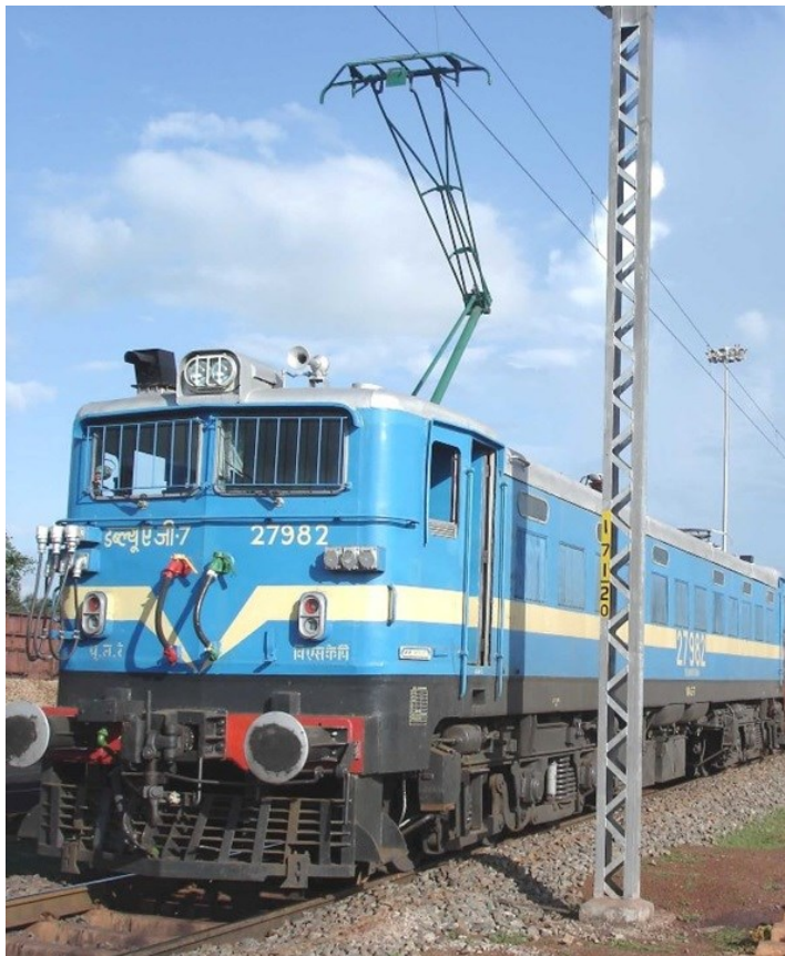
Magasépítésű áramszedővel rendelkező jármű (India)
