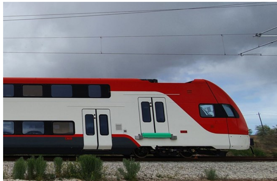
Dupla ajtós jármű két peronmagasság kiszolgálására (Stadler KISS, USA, Kalifornia)
