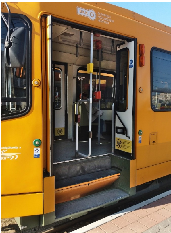
Lenyíló ajtós jármű két peronmagasság kiszolgálására (Budapest, (korábban: Hannover, Németország))
