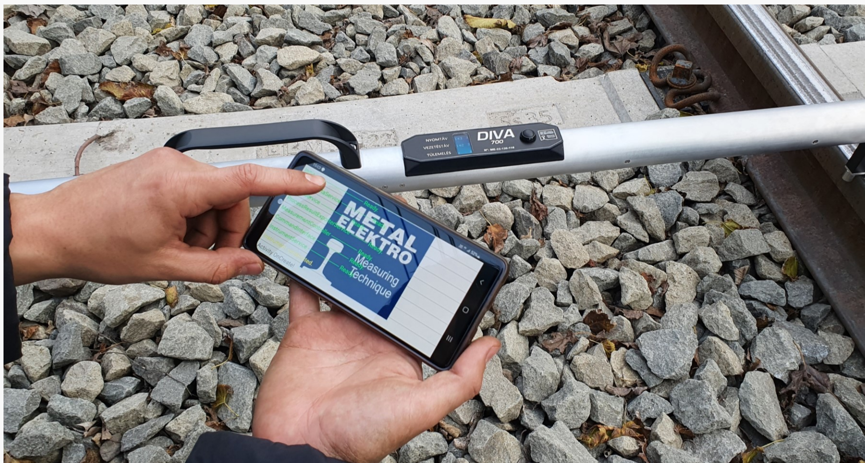
DIVA 700 - Digitális vágánygeometrikus mérőszelvény
