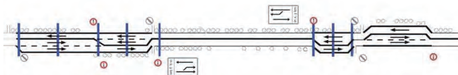
4.13.1. ábra. Előzési sávós utakon az előzési sávok nyitása, közepe és zárása kritikus és nem kritikus átmenetekkel a keresztmetszet változásakor (vázlatrajz)
